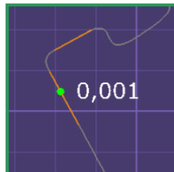
Imagen 9. Best Fit correcto. Hay una correcta superposición entre ambos archivos.
